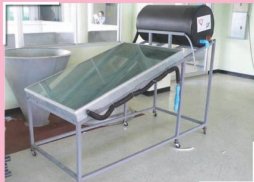
รูปที่ 11 การประกอบเครื่องทำน้ำร้อนพลังงานแสงอาทิตย์
