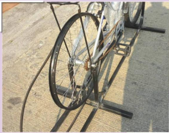
รูปที่ 4 แสดงการติดตั้งจักรยานเข้ากับโครงสร้าง
