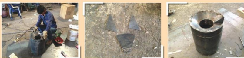
(13) ประกอบตัวเตากับ ห้องเผาไหม้ และฝาเตา
