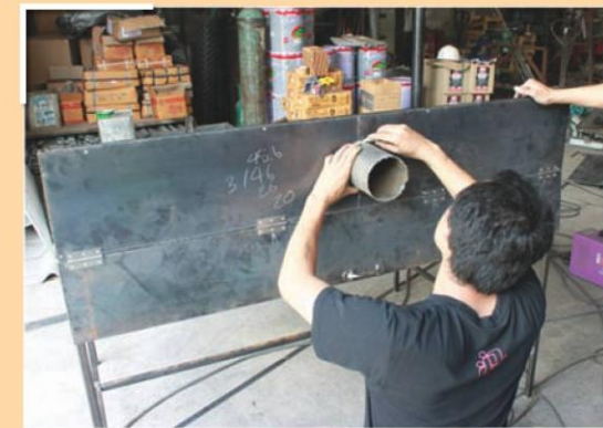
รูปที่ 6 กำหนดขนาดเจาะช่องพัดลม โดยใช้ข้อ 4 นิ้ว
