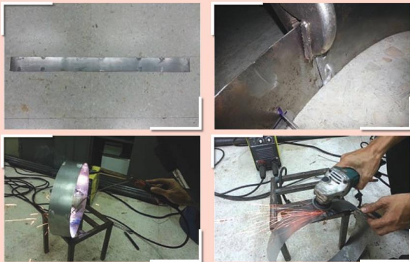
รูปที่ 2 แสดงการทำฝาครอบเตาแก๊ส
