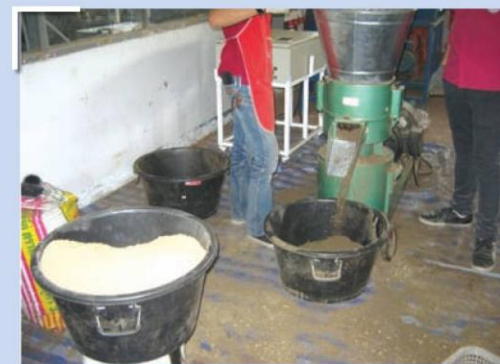
รูปที่ 10 แสดงการอุ่นเครื่องโดยใช้ขี้เลื่อยผสมกับน้ำมันเครื่องใช้แล้ว
