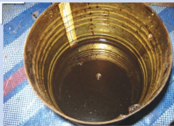
รูปที่ 8 แสดงการผสมตัวประสานสำหรับการอัดเม็ดชีวมวล
