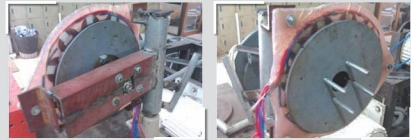
รูปที่ 27 ชุดติดตั้งเครื่องกำเนิดไฟฟ้า
