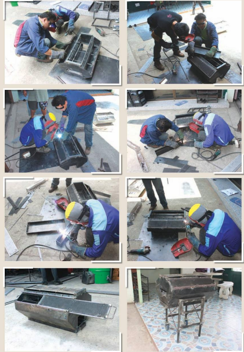
รูปที่ 3 การเชื่อมชิ้นรูปเตา
