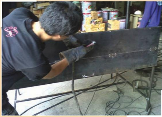
รูปที่ 7 ทำการเจาะช่องพัดลมโดยใช้หัวเชื่อมแก๊ส
