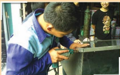
รูปที่ 10 แสดงการติดตั้งกระจกบนตู้อบ
