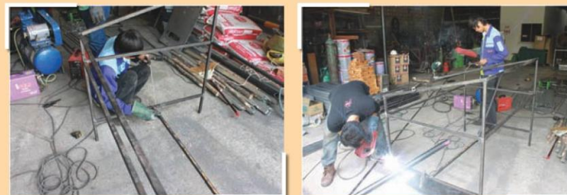
รูปที่ 3 แสดงขั้นตอนการขึ้นรูปตู้อบแห้งพลังงานแสงอาทิตย์
