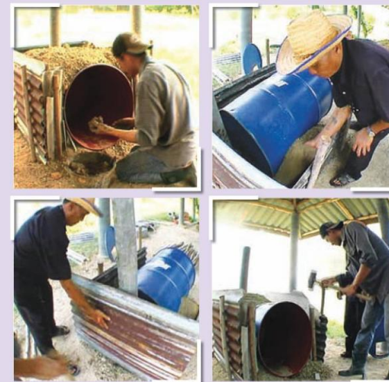
รูปที่ 4 แสดงสร้างเตาเผาถ่าน 200 ลิตร แบบนอน
