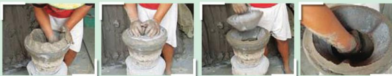
รูปที่ 9 การปั้นโดยใช้พิมพ์นอกและพิมพ์ในช่วยในการตกแต่งโพรงเตา
