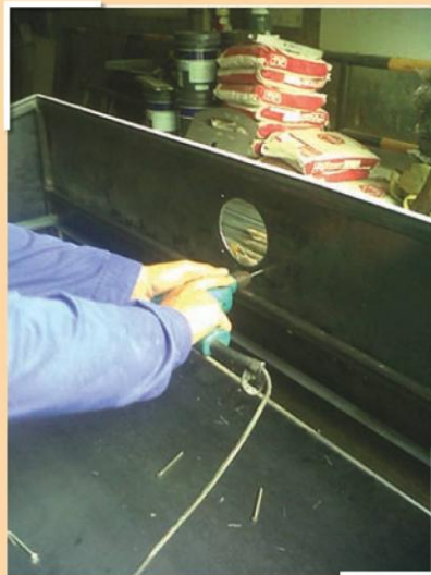
รูปที่ 8 การติดตั้งพัดลมระบายอากาศเข้ากับตู้อบ
