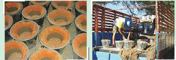
รูปที่ 16 การฝังเตา การตกแต่งและการเจาะปากเตา
