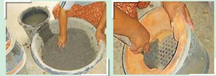
รูปที่ 15 การฝังเตา การตกแต่งและการเจาะปากเตา
