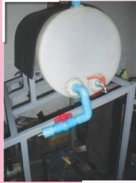
รูปที่ 10 ถังเก็บน้ำร้อน
