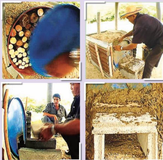
รูปที่ 11 แสดงการปิดเตาและประกอบช่องใส่ไฟ
