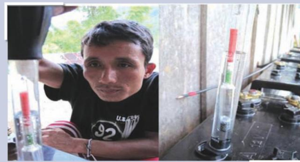
รูปที่ 26 การวัดค่าความถ่วงจำเพาะของน้ำกลั่นแบตเตอรี่
