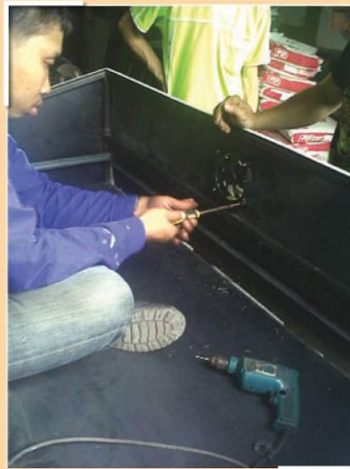
รูปที่ 8 การติดตั้งพัดลมระบายอากาศเข้ากับตู้อบ
