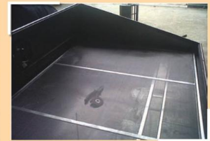
ติดตั้งตะแกรงดักแมลงสำหรับช่องระบายอากาศ และตะแกรงวางของในตู้อบ
