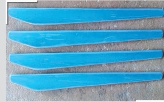
รูปที่ 10 ใบกังหันลมที่ทำจากท่อน้ำพีวีซีที่ทำการตกแต่งเรียบร้อยแล้ว
