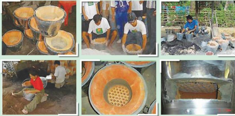
รูปที่ 14 การนำเตาเผาเสร็จแล้วมาใส่กรอบสังกะสี แล้วอัดดินผสมเคลือบคำก่อนจะใช้ซีเมนต์ทาปิดทั้งขอบสังกะสีและตัวเตา
