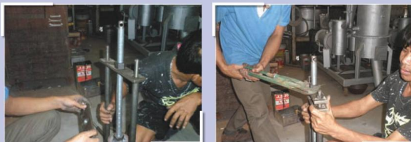
รูปที่ 4 แสดงการประกอบชุดหัวอัดหีบสบู่ดำ
