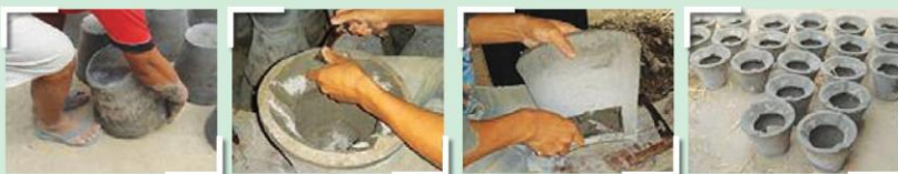
รูปที่ 10 การผึ่งเตา การตกแต่งและการเจาะปากเตา
