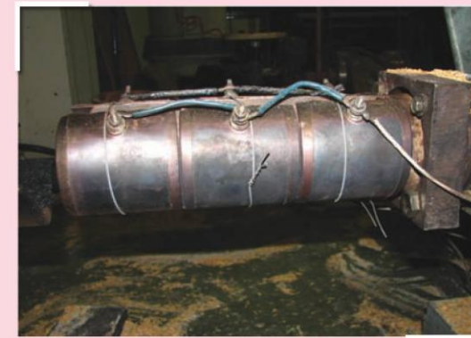
รูปที่ 4 กระบอกอัดเกลบพร้อมฮีดเตอร์ขนาด 3,000 วัตต์
