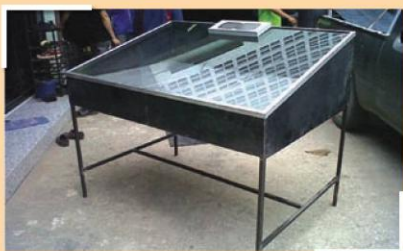
รูปที่ 12 ตู้อบแห้งพลังงานแสงอาทิตย์ที่สร้างเสร็จแล้ว
