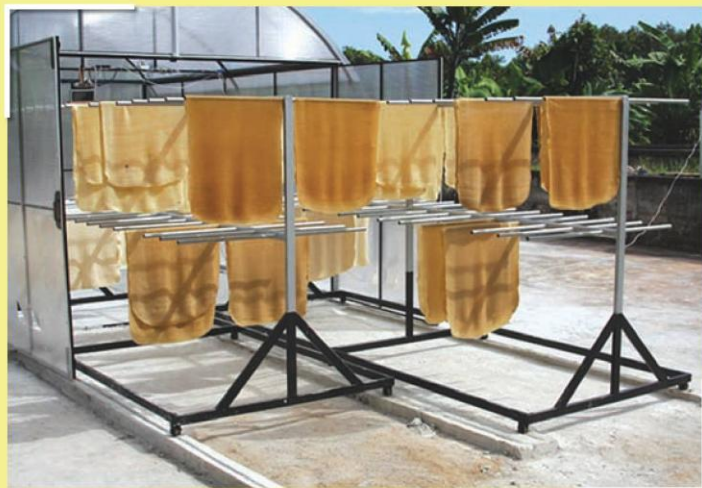
รูปที่ 2 แสดงองค์ประกอบห้องอบแห้งพลังงานแสงอาทิตย์สำหรับยางพาราและอาหารทะเล
