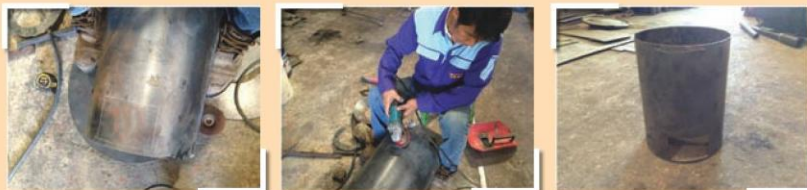
(5) ตัดช่องปรับอากาศที่เปลือกเตา และเปลือกเตาด้านใน
