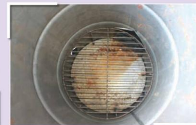
รูปที่ 21 แสดงการติดตั้งตะแกรงรองฟืน
