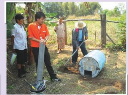
รูปที่ 6 แสดงการวางตำแหน่งของเตาเผาถ่าน 200 ลิตร แบบนอน
